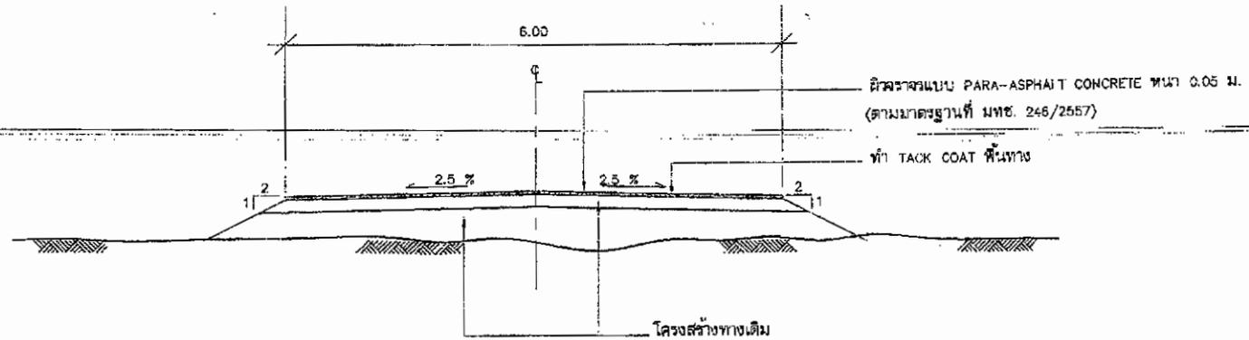
รูปตัดโครงสร้างทางผิวจราจรแบบ PARA-ASPHALT CONCRETE ช่วง กม.0+150 - กม.1+275
