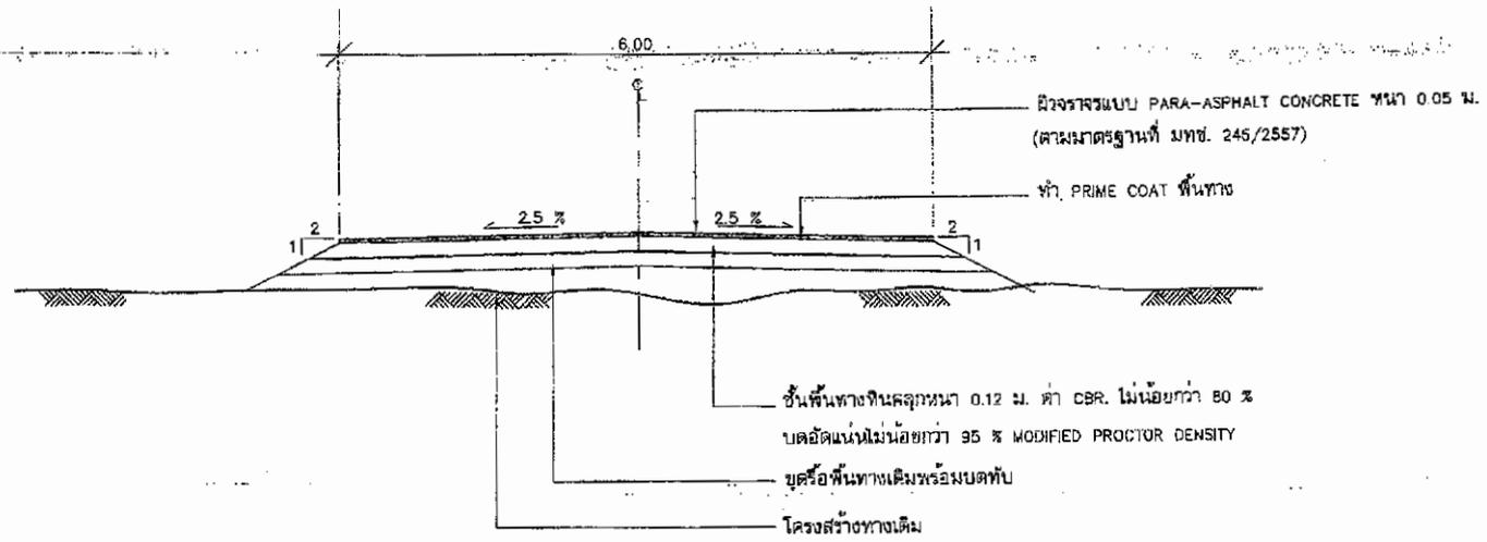
รูปตัดโครงสร้างทางผิวจราจรแบบ PARA-ASPHALT CONCRETE ช่วง กม.0+000 - กม.0+150
